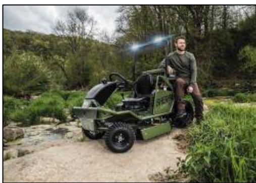
Illustration 4 : D'autres caractéristiques : une garantie de 60 mois et les pneus basse pression qui sont remplis en série de liquide anti-crevaisson d'AS-Motor
